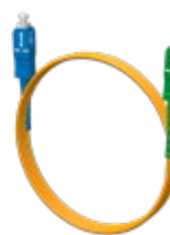
KOC-LSM-SPC-9-SC/U-SC/A-3.0-x Шнур SIMPLEX SC/UPC-SC/APC 9/125 3.0 мм LSZH, 1/2/3/5 м (x)
