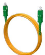
KOC-LSM-SPC-G.657.A1-SC/A-SC/A-3.0-xx Шнур SIMPLEX SC/APC-SC/APC 9/125 3.0 мм LSZH, 15/20/25/30/35/40 м (xx)
