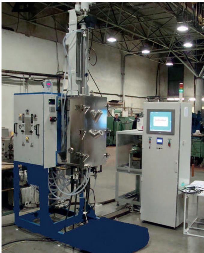
Установка предназначена для плавления, синтеза и выращивания методом Чохральского монокристаллов антимонида индия (InSb) и галлия (GaSb) с последующим отжигом выращенного кристалла.
