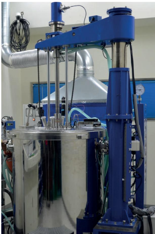
Предназначены для выращивания монокристаллов лейкосапфира из расплава. Метод Киропулоса характеризуется малыми температурными градиентами на фронте кристаллизации. К основным преимуществам относятся техническая простота процесса и возможность выращивания кристаллов больших размеров (>500 кг) с низкой плотностью дислокаций.
