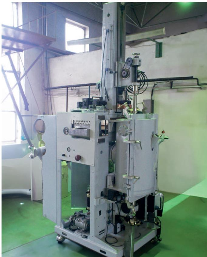
Предназначены для выращивания монокристаллов арсенида галлия (GaAs) и арсенида индия (InAs). Выращивание производится по методу Чохральского с жидкостной герметизацией расплава (LEC).
