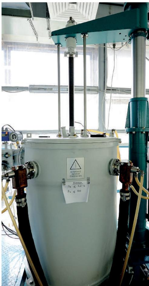
Предназначены для выращивания монокристаллов лейко-сапфира и рубина. Методом Бриджмена-Стокбаргера выращивают кристаллы по любой кристаллографической оси, что позволяет существенно увеличить выход годного продукта и снизить затраты на последующую обработку
