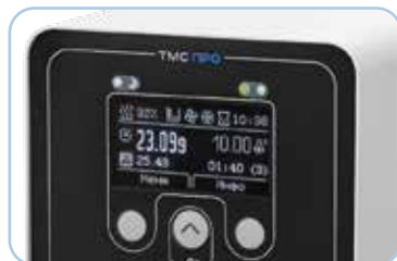
Удобное управление с контекстными кнопками и OLED дисплеем
